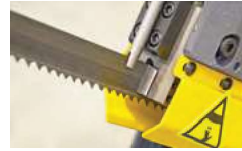
Sägebandführung aus Hartmetall
