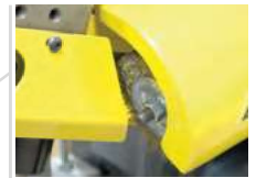
Bürste zur Reinigung des Sägebands
