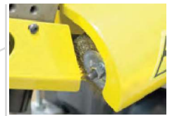
Bürste zur Reinigung des Sägebands
