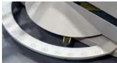
Übersichtliche, auf der Vorderseite der Maschine angebrachte Winkelskala
