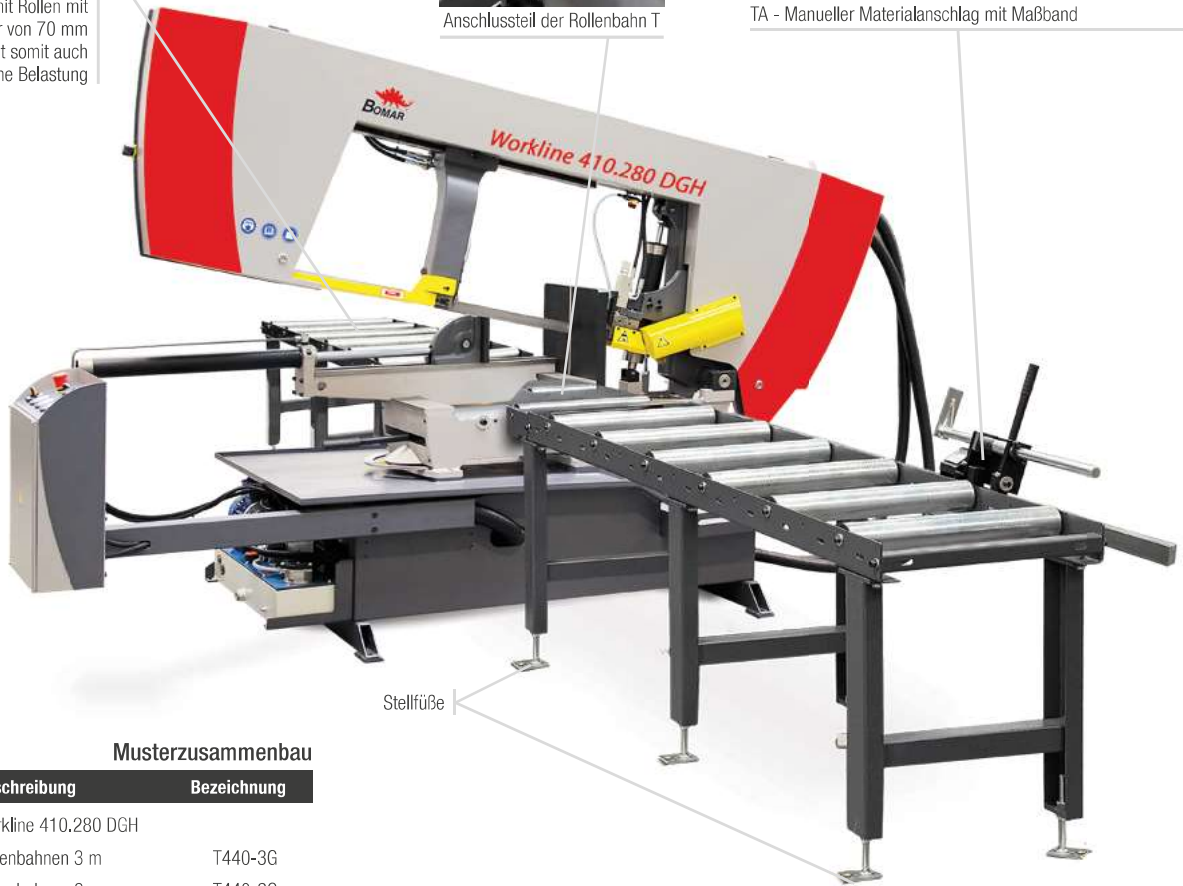
TA - Manueller Materialanschlag mit Maßband
