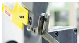
Sägebandführung aus Hartmetall
