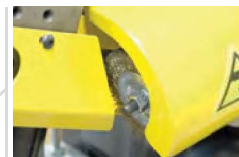
Bürste zur Reinigung des Sägebands
