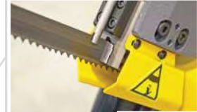
Sägebandführung aus Hartmetall
