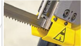
Sägebandführung aus Hartmetall
