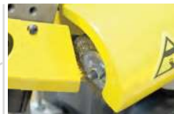
Bürste zur Reinigung des Sägebands
