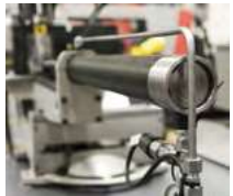
Vollhubzylinder des Spannstocks
