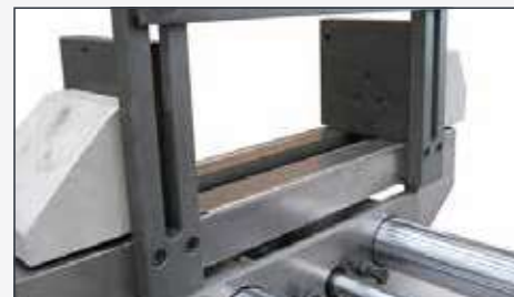
Telaio di contenimento. Frame for bar cutting.
