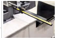
Möglicher Anschluss des Längenaufschlags
